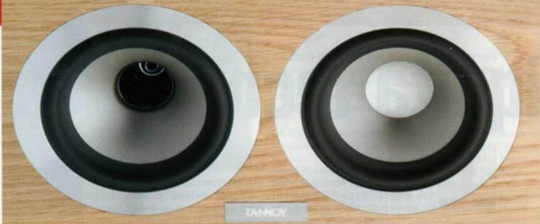
Nel driver coassiale, piccolo gioiello tecnologico sviluppato da Tannoy, il tweeter ha una cupola in titanio da 19 millimetri ed il magnete al neodimio, mentre il woofer ha 96 millimetri di diametro "utile" di impasto di cellulosa ed una bobina mobile da 33 millimetri. Notare il cestello e la schermatura totale. Nel midwoofer "normale", quello a destra, che non utilizza il driver coassiale ed è apparentemente identico nella foggia e nella costruzione, si può notare la larga cuffia parapolvere.
